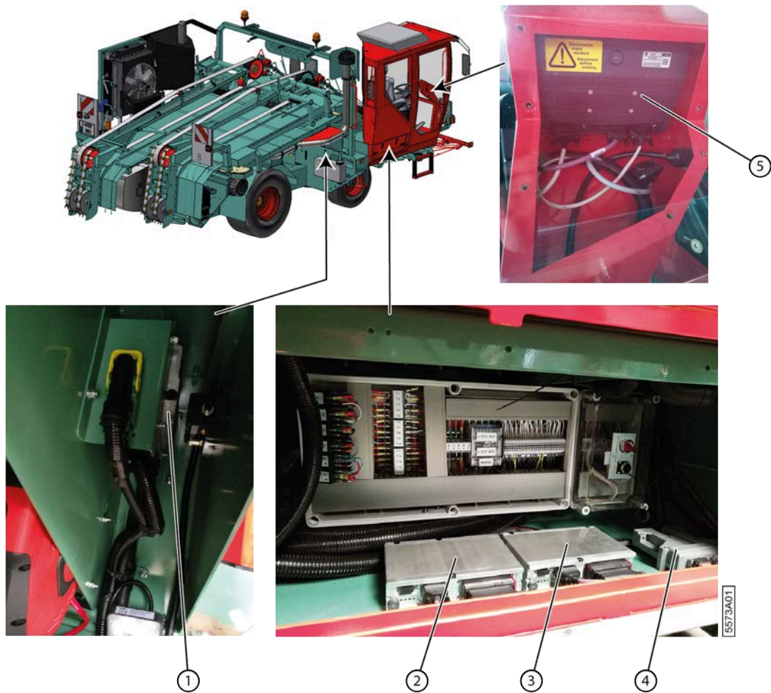
Fig. 160: Emplacement des contrôleurs
