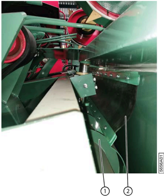
Fig. 139: Vérifier l'état du rabat en caoutchouc sur le vérin
