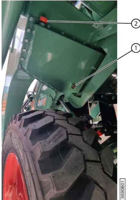
Fig. 108: Faire l'appoint d'huile de l'engrenage de l'arracheur
