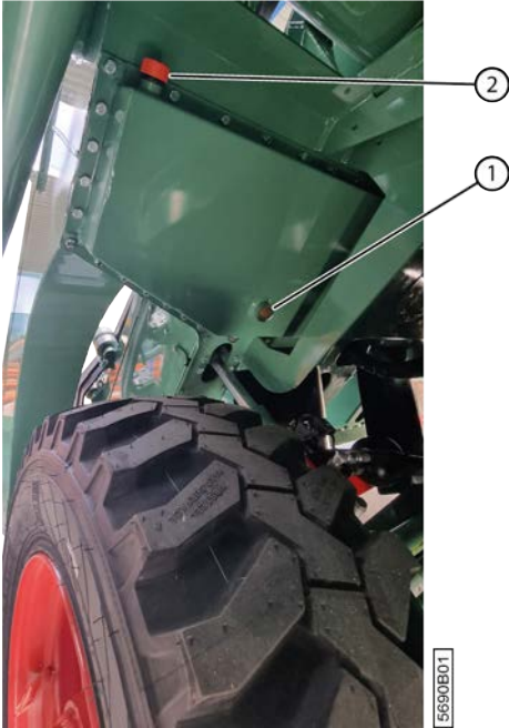
Fig. 107: Contrôle l'huile de l'engrenage de l'arracheur
