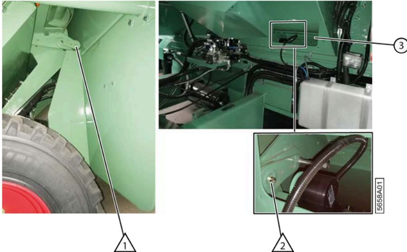
Fig. 141: Lubrifier les points charnières de l'arracheur
