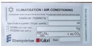
Fig. 151: Autocollant avec informations sur l'air conditionné
