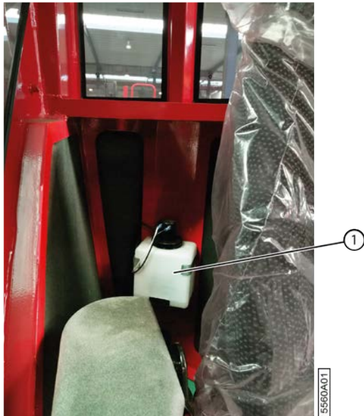
Fig. 15: Réservoir du liquide lave-glace
