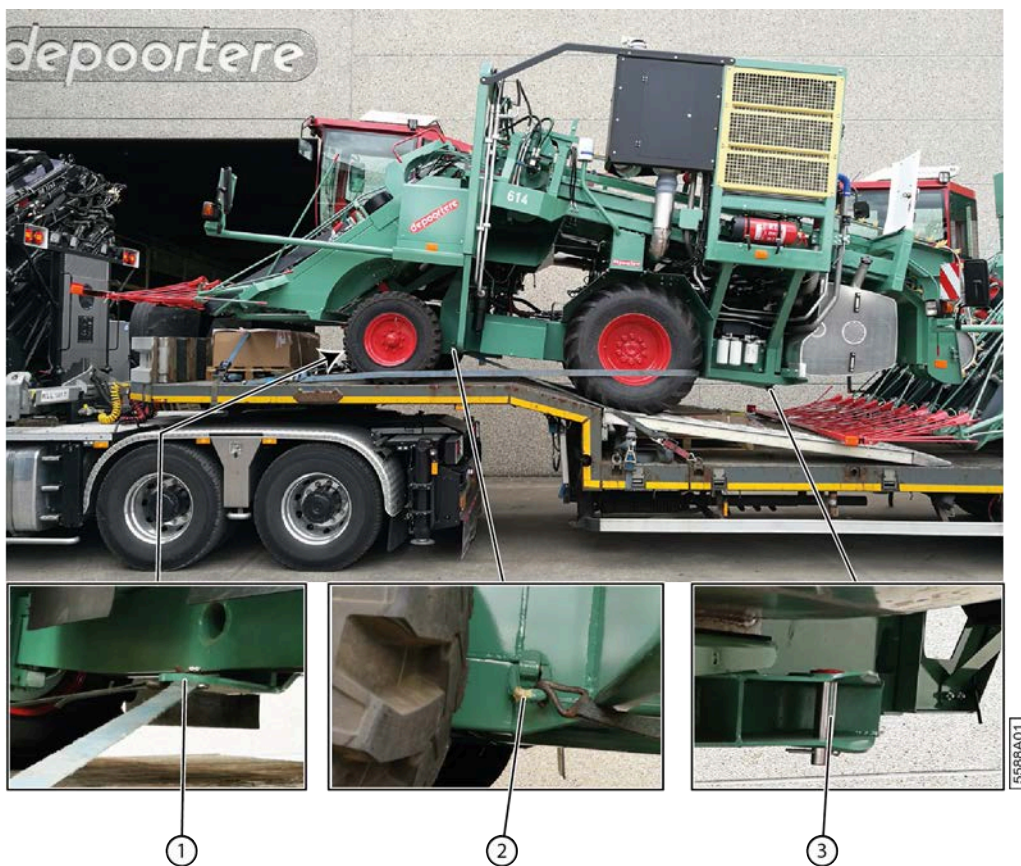
Fig. 49: Charger la machine sur le camion
