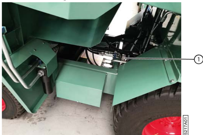
Fig. 176: Filtre du circuit de freinage
