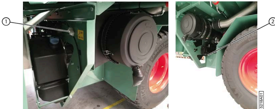
Fig. 175: Localisation des filtres AdBlue
