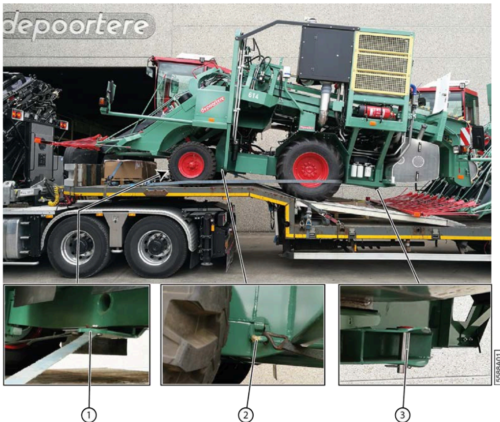
Fig. 50: Décharger la machine du camion
