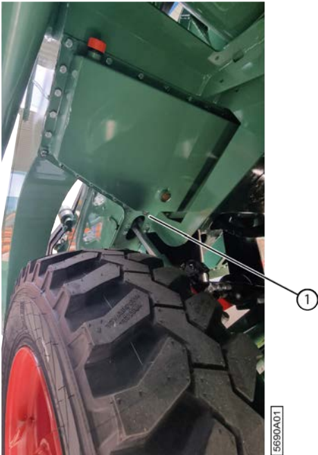
Fig. 109: Vider l'huile de l'engrenage de l'arracheur
